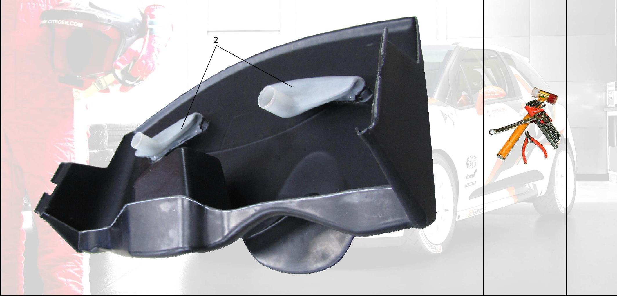
Installer la planche de bord dans la voiture. Positionner un morceau de mousse de dimension 100x100x70 sur le tablier afin de maintenir le centre de la planche de bord à niveau.
